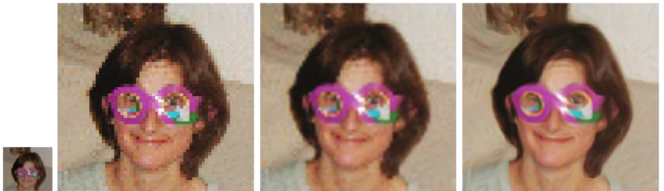
(g) Agrandissement ( \times 4 ) d'une image couleur 64 \times 64 , avec (de gauche à droite) : interpolation par bloc, interpolation linéaire, méthode EDP
